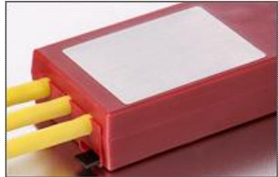
KONTRONIK empfiehlt die Fixierung des Kühlkörpers an einem JIVE Drehzahlsteller mittels metallklebenden Cyanacrylat (*Sekundenkleber*) vorzunehmen. Dünnflüssiges Cyanacrylat minimiert den Luftspalt zwischen JIVE und Kühlkörper und fördert somit die Wärmeleitung. Die Verklebung kann jedoch kaum gelöst werden, da es dabei zu mechanischer Beschädigung des JIVE Drehzahlstellers kommen kann.
